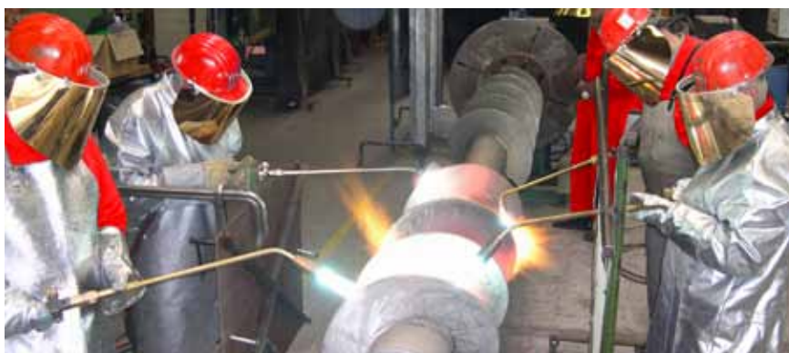
Проплавление порошкового сплава после напыления сплава
