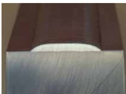
Износостойкое покрытие с минимальным растворение
